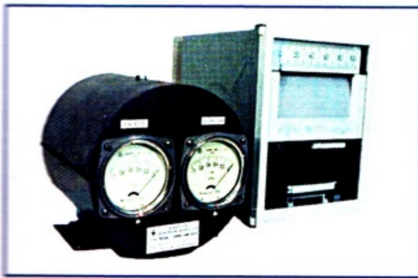
Рис. 1. Аппаратура манометрического контроля депрессии и производительности шахтных вентиляторов МАК-1000/100ШВ.
